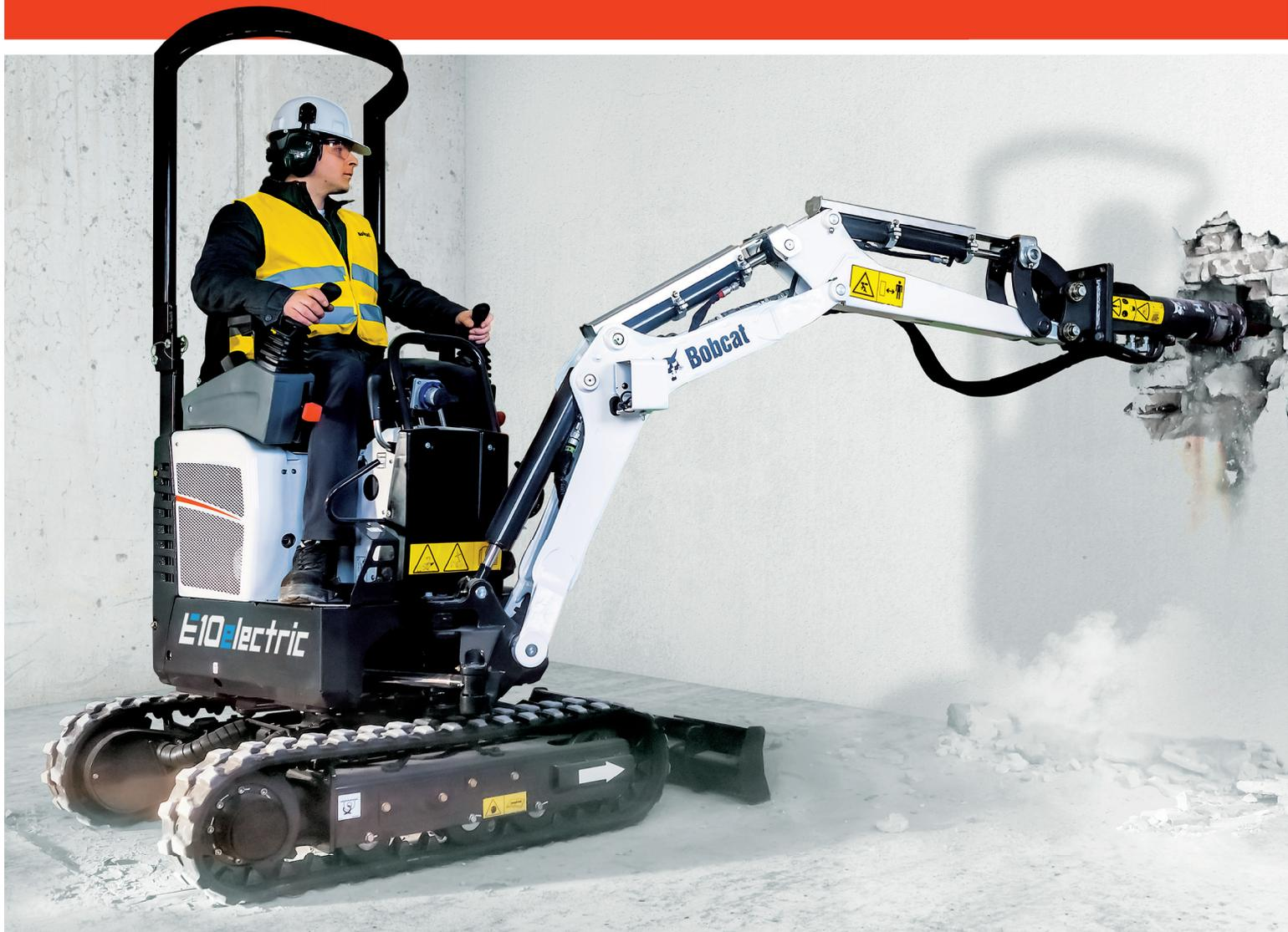
**Miniescavatore alimentato a batteria, senza ingombro posteriore (Zero Tail Swing – ZTS) nella classe da 1 tonnellata!**
